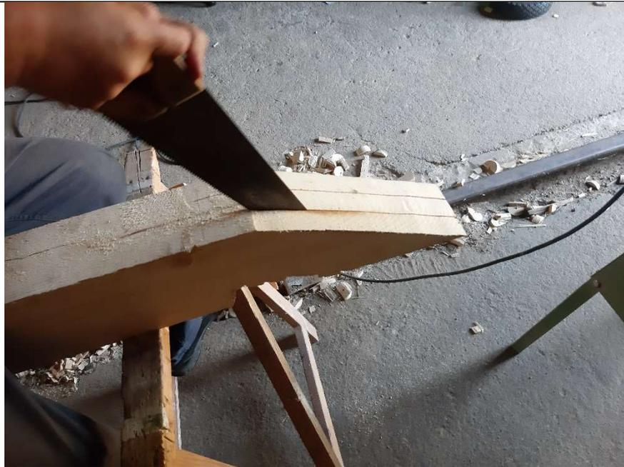
Teilweise – weil die Höhe mancher Balken zu groß für unsere Bandsäge ist – erfolgt das Sägen von Hand. (AT)
