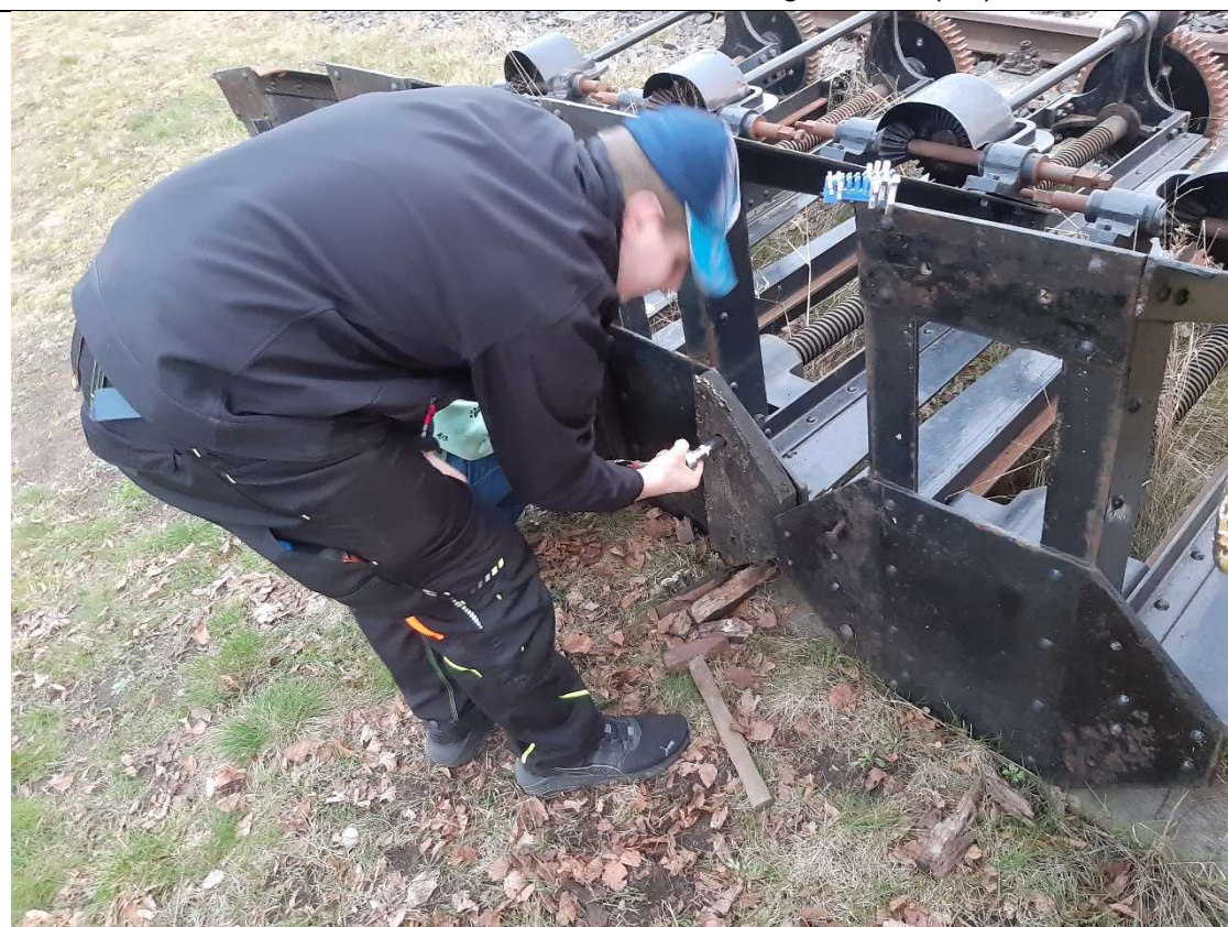
An den Hebeböcken wurden die alten Aufstellhölzer demontiert (AT)
