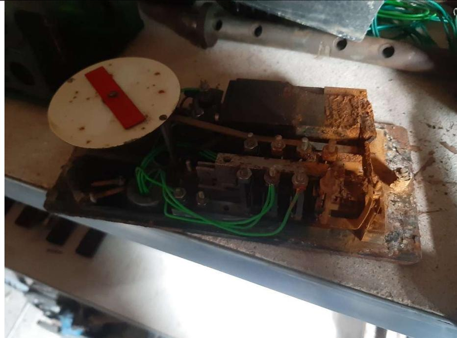
Am Signalmelder erkennt man gut, welche Schäden das undichte Dach angerichtet hat.
